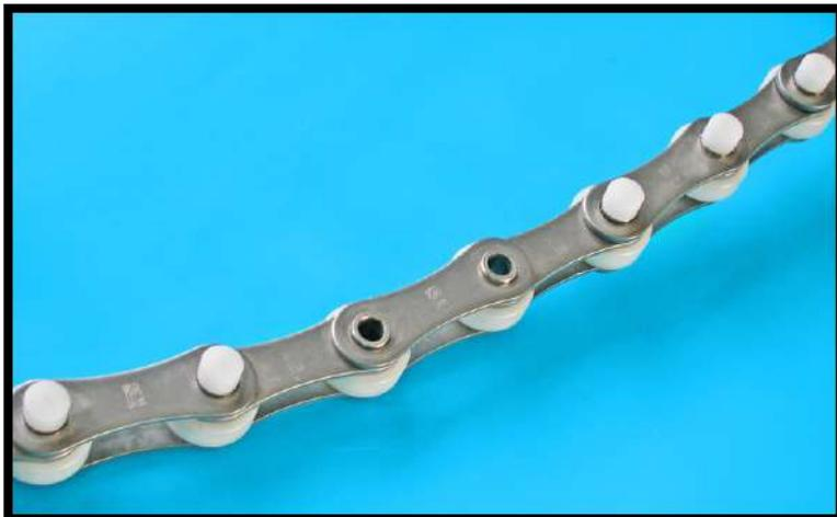
Cadenas Paso 2"/50 mm de acero inoxidable para elaboración de helados en forma industrial. Aptas para trabajo a - 220 °C. Con pernos prolongados o placa rígida de doble paso con rodillo termoplástico mecanizado y salvapernos en resina acetel.
