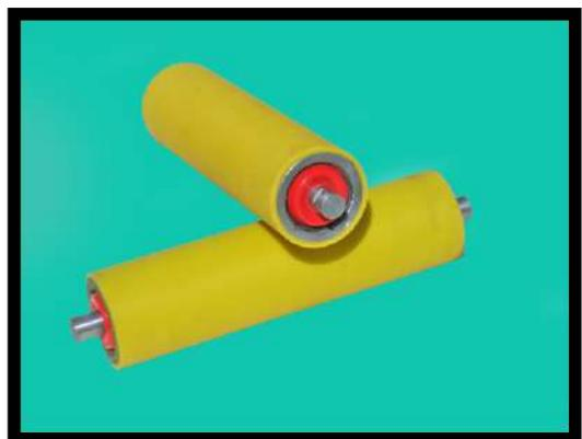
Construidos con tubos de acero cincado, P.V.C., Aluminio o acero inoxidable. Tapas laberinticas y rodamientos de precisión con doble blindaje y eje fijos ó retráctiles. A pedido: con recubrimiento de poliuretano
