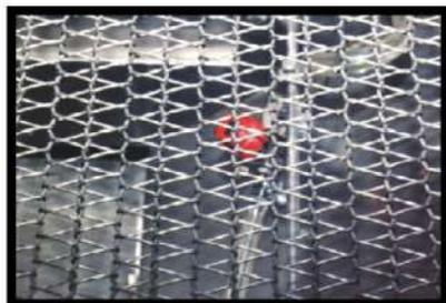
Cintas transportadoras para túneles de termocontracción.
